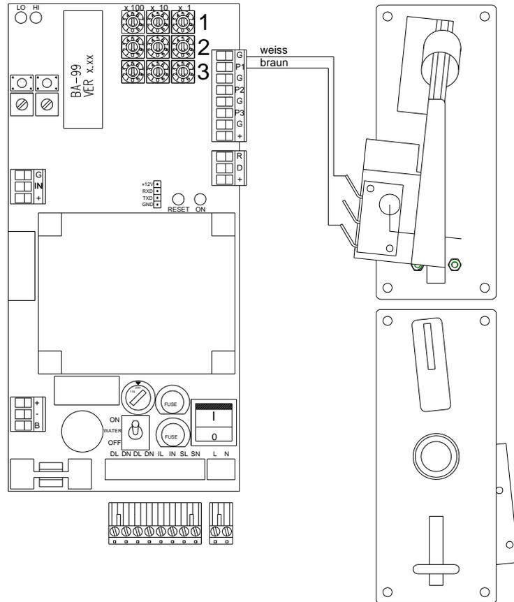
Abb. 28: Anschlussschema der mechanischen Münzkontrolle – eine Münze.
