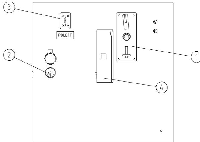
Abb. 36: Schaltschrank, Marken, Magnetkartenlesers EMC-30 und mechanische Münzkontrolle
