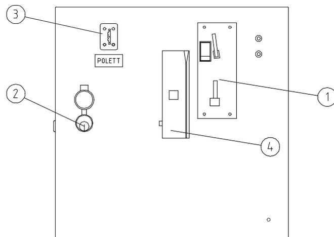
Abb. 37: Schaltschrank, Marke, Magnetkartenlesers EMC-30 und elektronische Münzkontrolle
