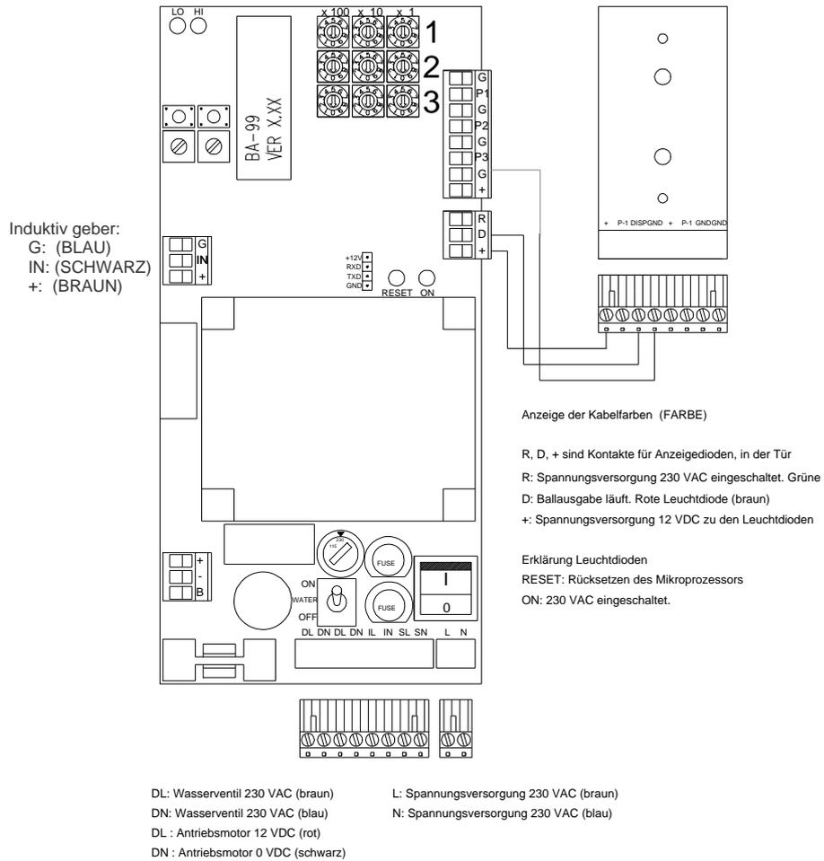
Abb. 26: Schaltplan für Anschluß des Ballautomaten Modell RS-11/18.
