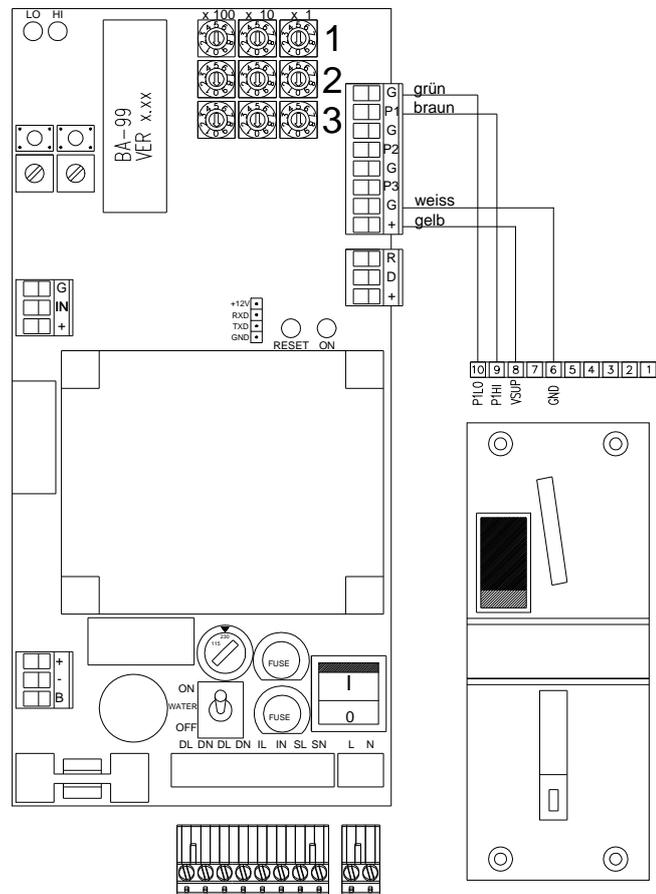
Abb. 30: Anschluß der Münzkontrolle Mars® Cashflow 340.
