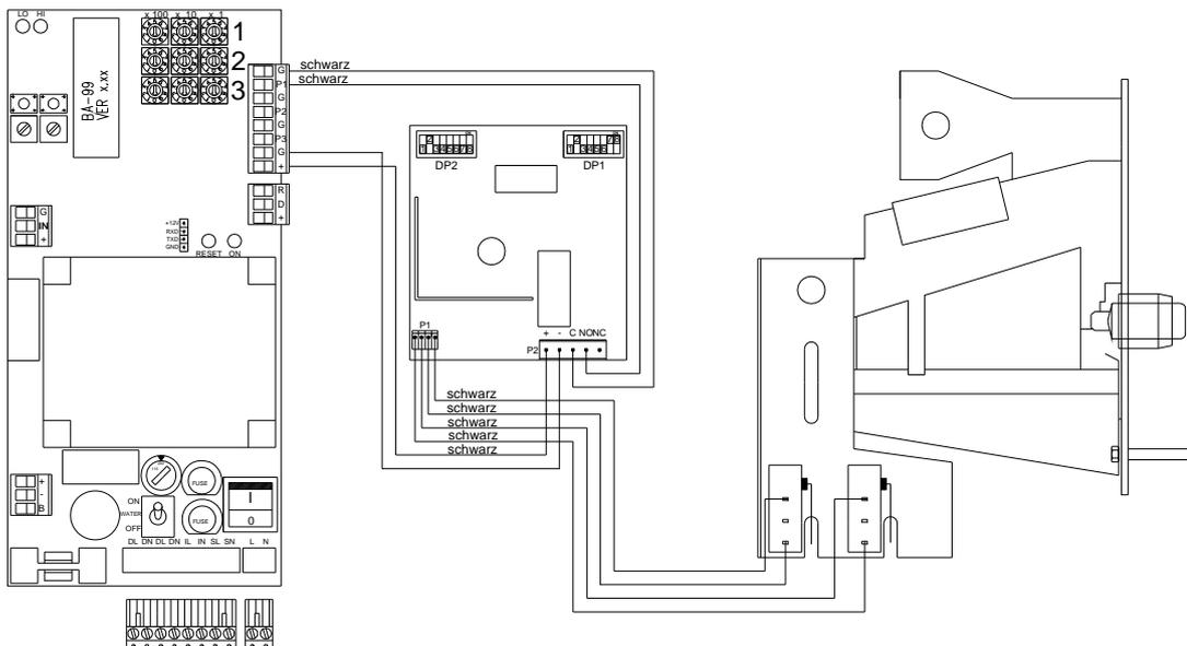
Abb. 29: Schaltung der mechanischen Münzkontrolle - 2 Münzen mit Additionskarte
